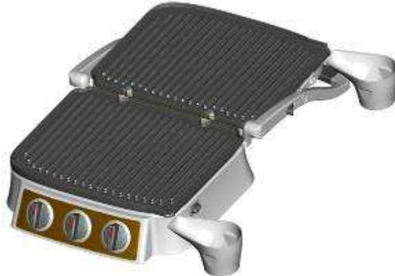
Om de bakplaat te gebruiken, dient u de grill volledig te openen door op de beveiligingsknop aan de zijkant (10) te drukken. U kunt vervolgens de grill volledig uitklappen en de bakplaat (8) op de hendel (2) laten rusten. Uw grill is voorzien van een grillplaat (6) en een vlakke bakplaat (8). De afbeelding toont de wijze waarop de opvangbakjes (11) gebruikt kunnen worden. De bakplaatknop (3) kan op verschillende temperaturen worden ingesteld.
