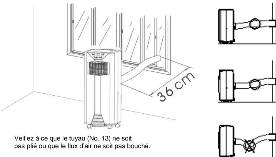
Veillez à ce que le tuyau (No. 13) ne soit pas plié ou que le flux d'air ne soit pas bouché.
