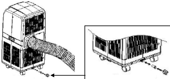
Si la condensation doit être constamment évacuée, mettez le tuyau d'évacuation de condensation (No. 19) sur le bec. Retirez le bouchon en caoutchouc. Le tuyau de purge de condensats peut être rallongé avec un autre tuyau (non fourni). Il peut être branché sur une évacuation ou dirigé vers l'extérieur. Veillez à ce que le tuyau ne remonte pas.
