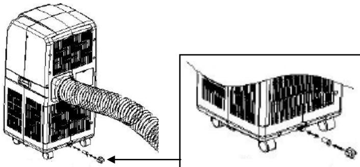
Wenn das Kondenswasser dauernd beseitigt werden muss, den Kondenswasser-Ablaufschlauch (Nr. 19) auf den Ausgießer setzen. Den Gummistöpsel entfernen. Der Kondenswasser-Ablaufschlauch kann mit einem anderen Schlauch (nicht im Lieferumfang enthalten) verlängert werden. Er kann an einen Ausguss angeschlossen oder nach draußen geführt werden. Dieser Schlauch darf nicht nach oben zeigen.
