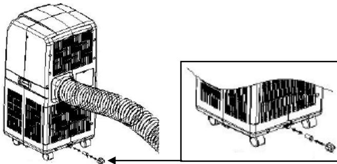
Ako se kondenzat mora neprekidno uklanjati, postavite crijevo za odvod kondenzata (br. 16) na izljevnik. Uklonite gumeni čep. Crijevo za odvodnju kondenzata se može produžiti drugim crijevom (nije isporučeno). Može se spojiti na odvod ili provesti van. Pobrinite se da crijevo ne bude okrenuto prema gore.
