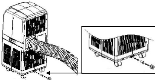
Indien het condenswater continue dient te worden afgevoerd, plaats dan de condenswater afvoerslang (nr.19) op de tuit. Verwijder wel eerst de rubberen plug. De condenswater afvoerslang kan met een andere slang (niet bijgeleverd) worden verlengt. Deze kan worden aangesloten op een afvoer of naar buiten worden geleid. Zorg dat deze slang niet omhoog loopt.
