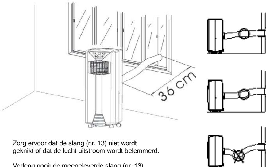
Zorg ervoor dat de slang (nr. 13) niet wordt geknikt of dat de lucht uitstroom wordt belemmerd.
