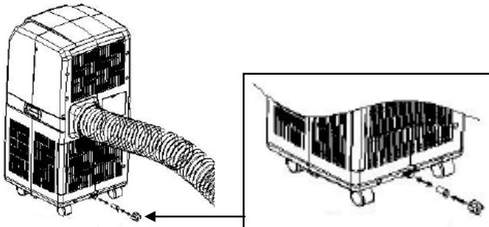
Si fuera necesario eliminar el agua procedente de la condensación de forma continua, coloque el tubo de drenaje de condensación (nº 19) en el pitón, quitando antes el tapón de goma. Si fuera necesario, prolongue el tubo de drenaje de condensación con otro tubo auxiliar (no incluido). Puede conectarlo a un desagüe o conducirlo hasta el exterior. Asegúrese de que este tubo no queda orientado hacia arriba.
