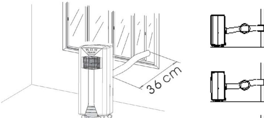
Der Schlauch (Nr. 13) darf nicht geknickt sein und der Luftstrom darf nicht blockiert werden.
