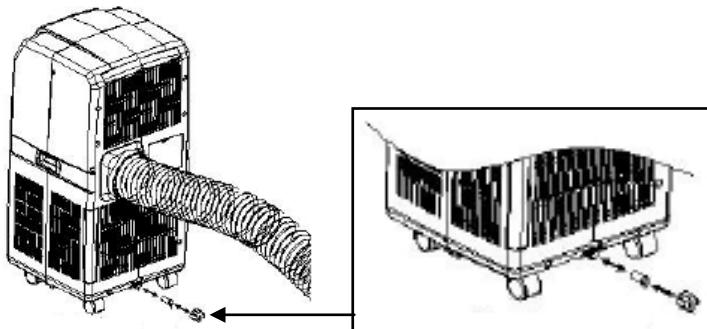
Se a condensação tiver de ser retirada continuamente, coloque a mangueira de drenagem da condensação (Nº 19) na torneira. Retire a válvula de borracha. A mangueira de drenagem da condensação pode ser estendida com outra mangueira (não fornecida). Pode ser ligada à drenagem ou conduzida para o exterior. Certifique-se de que esta mangueira não rebenta.
