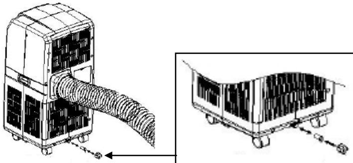
Se la condensa deve essere rimossa continuamente, collocare il flessibile condensazione (N° 19) sul beccuccio. Non rimuovere il tappo in gomma. Il flessibile spurgo condensa può essere allungato con un altro flessibile (non in dotazione). Può essere collegato a un dispositivo di spurgo o portato all'esterno. Controllare che il flessibile non sia piegato verso l'alto.
