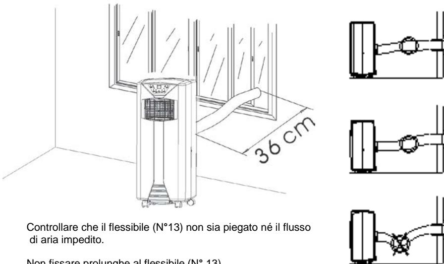
Controllare che il flessibile (N°13) non sia piegato né il flusso di aria impedito.
