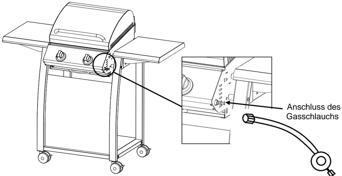
Schrauben Sie das Ende des Gasschlauchs links herum auf den dafür vorgesehenen Anschluss am Grill. Den Anschluss mit einem Schlüssel gut festdrehen, um Gasaustritt vorzubeugen!
