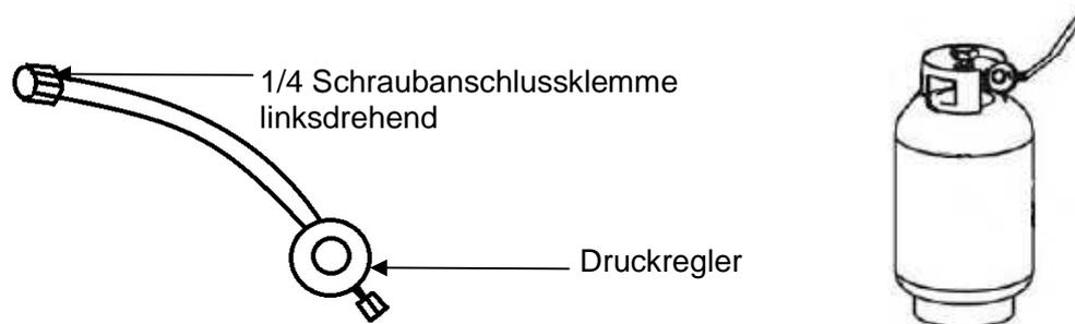
Schließen Sie den Druckregler an der Gasflasche an. Drehen Sie den Druckregler ausreichend fest um Gasaustritt vorzubeugen!
