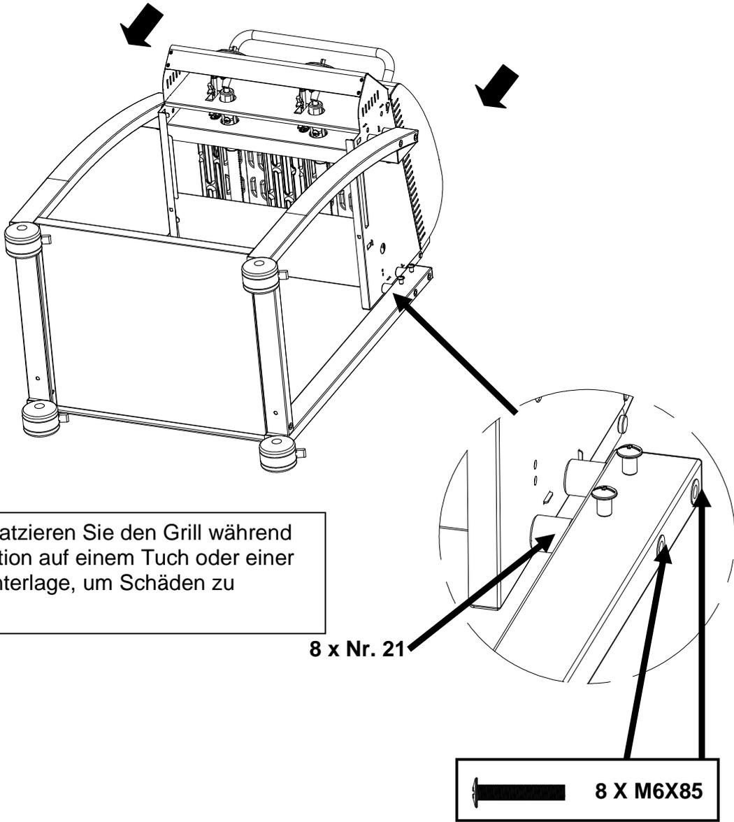
Hinweis: Platzieren Sie den Grill während der Installation auf einem Tuch oder einer weichen Unterlage, um Schäden zu vermeiden.
