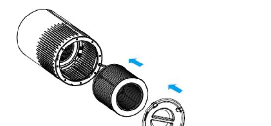
• Draaien Sie die Sockelabdeckung von der entriegelten in die verriegelte Position, wo sie hörbar einrasten sollte.
