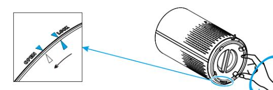
• Verwijder het basisdeksel en haal het filter eruit.
