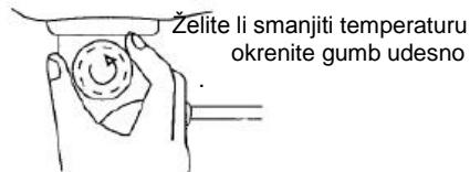
Termostat održava konstantnu temperaturu. Tijekom pečenja, indikator temperature će se uključivati i isključivati, što je normalno, jer se zadana temperatura stalno prilagođava.
