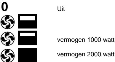
Voor verwarming draai de thermostaat schakelaar (nr. 2) met de klok mee naar de hoogste stand. Indien de gewenste kamer temperatuur bereikt is, draait u de thermostaat schakelaar tegen de klok in tot u een klik hoort. De thermostaat houdt nu de gewenste kamer temperatuur vast. Voor het gebruik als ventilator dient de thermostaat schakelaar (nr. 2) geheel naar links gedraaid te worden, het apparaat verwarmt nu niet, de ventilator draait wel.
