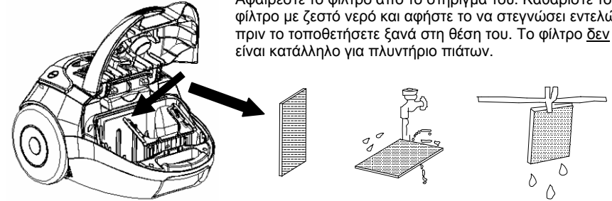
Καθαρισμός του φίλτρου εξαγωγής.
